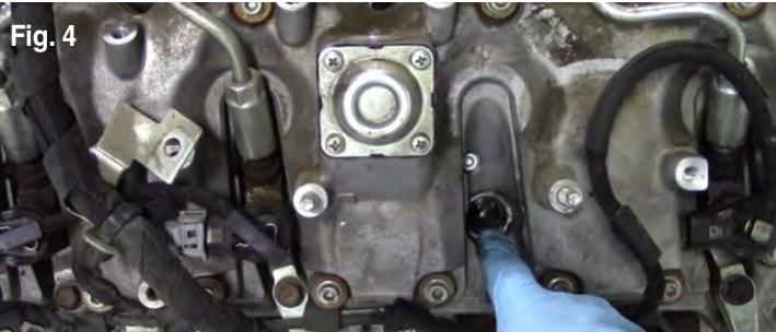
**8.** Inspeccione el orificio del inyector para ver si hay residuos y siga los siguientes pasos para asegurarse de que el orificio esté limpio y preparado para el nuevo inyector (Fig. 4).
