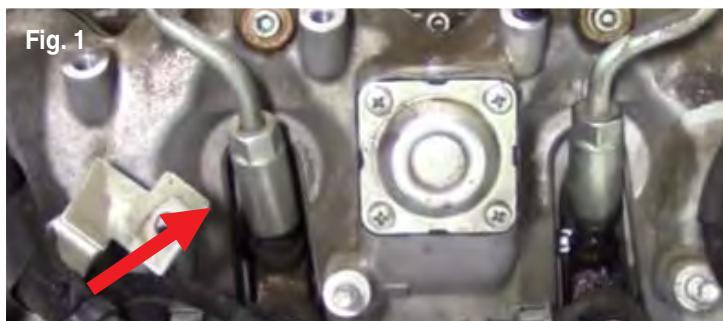
3. Utiliser un jet d'air comprimé pour débarrasser les zones adjacentes aux tubes d'alimentation de carburant de tous débris et contaminants susceptibles de s'être fragmentés et d'être tombés dans l'alésage de l'injecteur durant le retrait de celui-ci. Pulvériser ou appliquer un peu de graisse au lithium autour de l'extrémité des tubes afin de saisir les débris au moment de retirer les tubes (fig. 1).
