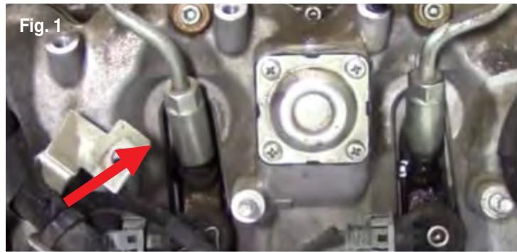
3. Con aire comprimido del taller, sople los residuos o contaminantes de los tubos de alimentación de combustible para asegurarse de que no queden sueltos y caigan en el orificio del inyector durante la extracción del inyector. Rocíe o aplique un poco de grasa de litio alrededor de los extremos del tubo para atrapar residuos potenciales a medida que se extraen los tubos (Fig. 1).
