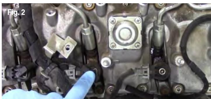
4. Débrancher les canalisations de retour de carburant des injecteurs. Faire attention de ne pas appliquer trop de force ou d'agiter le connecteur en T d'un côté et de l'autre. Retirer simplement la bride et tirer le connecteur en T pour l'enlever. Ce connecteur ne devrait pas opposer beaucoup de résistance au moment de l'enlever (fig. 2).
