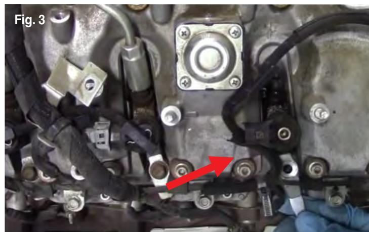
6. Retirer les boulons des supports d'injecteur et dégager l'injecteur avec l'outil GM numéro J-46954 ou insérer un tournevis à tête plate entre le support de retenue et le siège; agiter le tournevis de haut en bas jusqu'à ce que l'injecteur se dégage. L'usage d'une force excessive peut causer des dommages à d'autres composants ou endommager le moulage en fonte du vieil injecteur. Une fois que l'injecteur est dégagé, le retirer à la main (fig. 3).
