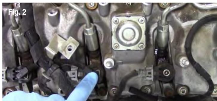
4. Desconecte la línea de retorno de combustible de los inyectores. Tenga cuidado de no aplicar demasiada fuerza o mover el conector en T de lado a lado. Simplemente retire la abrazadera y jale hacia arriba el conector en T. Debe haber muy poca resistencia al retirar (Fig. 2).
