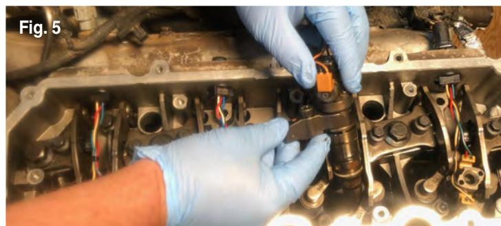
3. Une fois que les injecteurs sont visibles, utiliser un embout TORX T45 à TIGE LONGUE (fig. 5) pour retirer le boulon de retenue d'injecteur du collier de retenue d'injecteur. Enlever l'injecteur et son collier de retenue en même temps. Si plus d'un seul injecteur doit être remplacé, garder le collier et le boulon séparés et les réutiliser dans le même cylindre.
