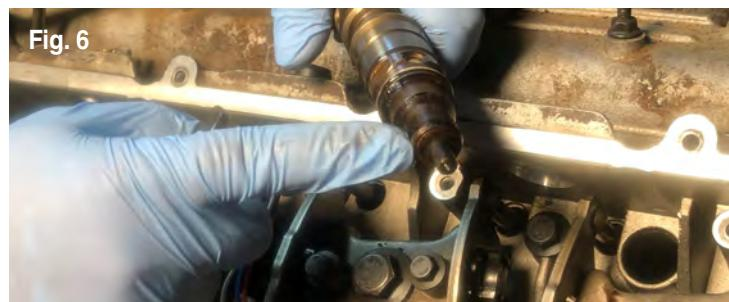
4. Revise el inyector y asegúrese de que la junta tórica de cobre alrededor de la boquilla haya salido junto con el inyector que va a reemplazar (Fig. 6).
