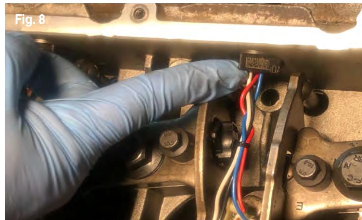
**7.** Ensuite, réinsérer le connecteur électrique dans le port d'où il a été retiré; un clic audible permet de s'assurer que le connecteur est bien branché. Il faut entendre ce clic, faute de quoi le connecteur de l'injecteur pourrait basculer et tomber (fig. 8).
