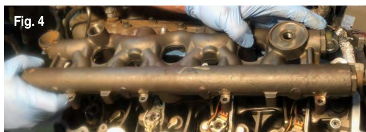
2. Retire el tubo vertical, el enchufe falso y los pernos del múltiple; seguidamente retire el múltiple del aceite de alta presión (Fig. 2 a 4).
