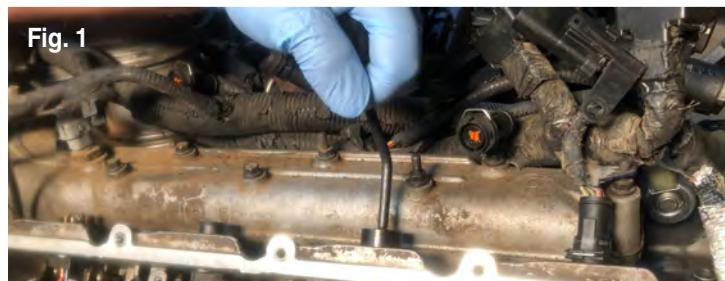
1. Débrancher le connecteur électrique des injecteurs au moyen de l'outil de dégagement spécial (fig. 1).
