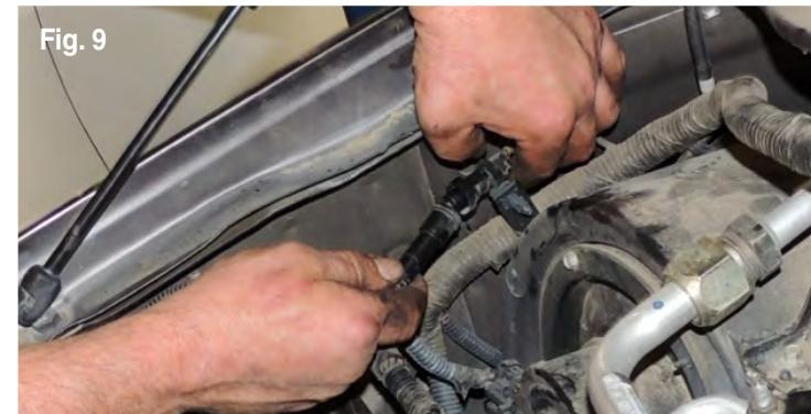
**11.** Antes de arrancar el motor, es fundamental que aumente la presión del aceite y que este llegue al nuevo inyector antes de hacerlo funcionar por primera vez. Si no lo hace, el nuevo inyector puede fallar inmediata o prematuramente. Para aumentar la presión del aceite, ubique el cable envuelto con protector negro que corre a lo largo del guardafangos del lado del pasajero que llega hasta el conector de desconexión rápida (Fig. 9).
