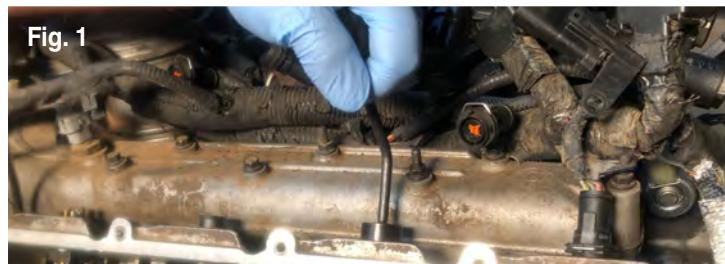
1. Desconecte el conector eléctrico del inyector de combustible con la herramienta especial de desconexión (Fig. 1).
