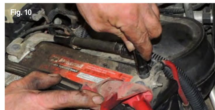
**12.** Desconéctelo y lleve el cable hasta el terminal positivo de la batería. Coloque el extremo del cable en el terminal y deje que el motor funcione durante 20 a 30 segundos (Fig. 10). Repita este paso 3 o 4 veces y luego vuelva a conectar el cable. Ya está listo para arrancar el motor.
