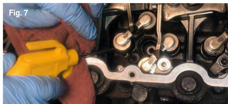
**NOTA:** Antes de instalar el nuevo inyector, limpie con aire a presión el aceite y otros fluidos del agujero del perno de sujeción del inyector.
