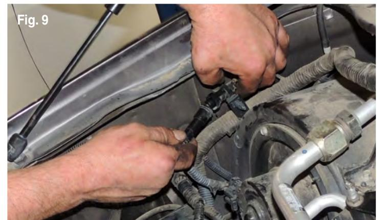
**11.** Avant de mettre le moteur en marche, il est crucial que la pression d'huile ait monté et que l'huile ait atteint le nouvel injecteur avant son fonctionnement initial, faute de quoi l'injecteur subirait une défaillance prémature immédiate. Pour que la pression d'huile monte, localiser le fil enveloppé d'une gaine noire acheminé le long de l'aile du côté passager jusqu'au dispositif à débranchement rapide (fig. 9).
