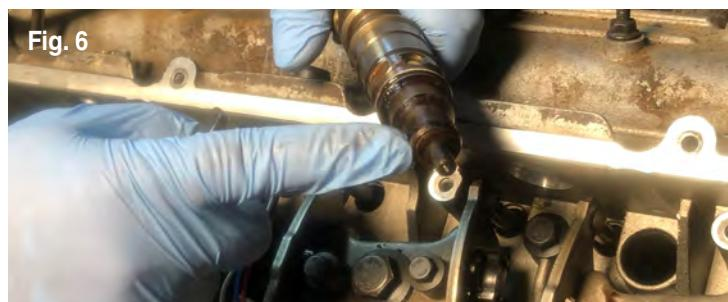
4. Examiner l'injecteur et s'assurer que le joint torique en cuivre qui se trouve autour de la buse a été retiré avec l'injecteur qui doit être remplacé (fig. 6).
