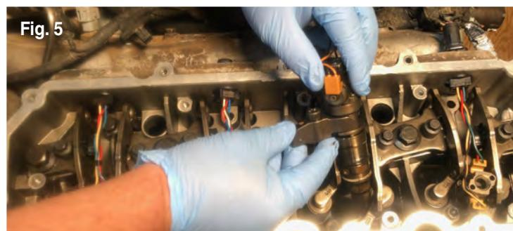
3. Una vez que estén visibles los inyectores, con una broca T45 TORX de VÁSTAGO LARGO retire el perno de sujeción del inyector del collarín de sujeción del inyector (Fig. 5). Luego retire el inyector y el collarín al mismo tiempo. Si va a reemplazar más de un inyector, guarde el collarín y el perno y vuelva a utilizarlos en el mismo cilindro.
