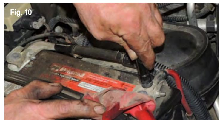
**12.** Débrancher et déplacer le fil jusqu'à la borne positive de la batterie. Placer l'extrémité du fil sur la borne et laisser le moteur tourner durant 20 à 30 secondes (fig. 10). Répéter cette étape de 3 à 4 fois, puis rebrancher le fil. Le moteur peut maintenant être mis en marche.
