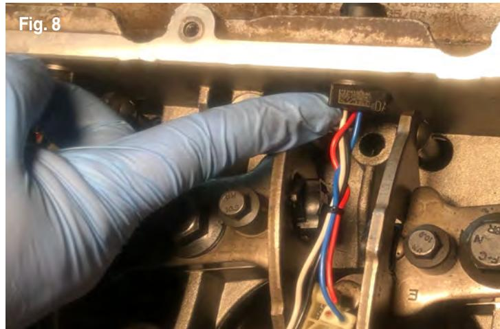
**7.** Al terminar, vuelva a colocar el conector eléctrico en su puerto y escuche el chasquido que asegura la conexión. Si no lo hace, el conector del inyector puede caerse (Fig. 8).
