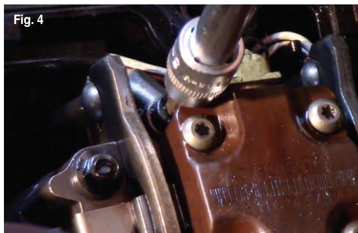
3. Quite el perno y el deflecto de aceite de la placa de sujeción del inyector de combustible. Si va a reemplazar más de un inyector, asegúrese de guardar cada perno y deflecto con el cilindro original de donde se quitaron (Fig. 4).
