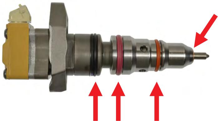
5. Después de desinstalar el inyector, es muy importante inspeccionar el núcleo para asegurarse de que los 3 sellos y la arandela de cobre hayan salido con el inyector. Si no lo hace podría causar una situación con dos empaquetaduras, lo cual ocasionará un fallo prematuro, pérdida de aceite de alta presión y daño al inyector (Fig. 6).
