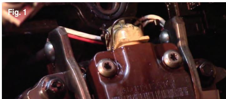
1. Desconecte el arnés de conexiones eléctricas que está en la empaquetadura de la cubierta de la válvula de cada inyector (Fig. 1). Para facilitar la desinstalación e instalación, recomendamos desconectar y desinstalar toda la empaquetadura mientras se siguen los pasos siguientes.
