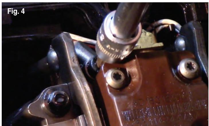
3. Retirer le boulon et le déflecteur d'huile de la plaque de retenue de l'injecteur. Si plus d'un injecteur doit être remplacé, s'assurer de conserver chaque boulon et chaque déflecteur avec le cylindre duquel ils ont été retirés (fig. 4).
