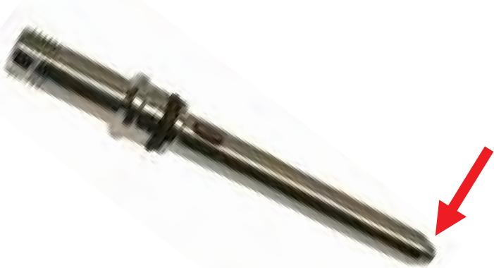
10. Como se mencionó al inicio de esta guía, se recomienda cambiar los tubos del conector. Si los va a volver a utilizar, inspeccione el cono del conector. Si encuentra ranuras o daños visibles, la capacidad del conector para crear un sello es poco probable y habrá una fuga (Fig. 6).
