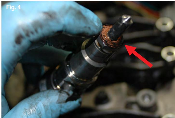
5. Después de liberar el inyector, verifique visualmente que también salió la arandela de cobre alrededor de la boquilla. Si no fue así, revise el orificio y retire la arandela. Si no lo hace, el inyector de reemplazo no se apretará al par apropiado y habrá fuga (Fig. 4).
