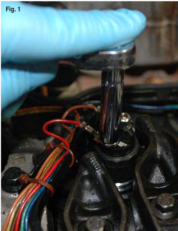
2. Retirer les écrous des connecteurs électriques de l'injecteur et déplacer le faisceau à l'écart de celui-ci. Les écrous font partie intégrante du faisceau électrique; s'ils se séparent du faisceau, prendre soin de ne pas les laisser tomber dans le moteur et, le cas échéant, de ne pas les réutiliser. Installer un joint de couvercle de soupapes neuf.
