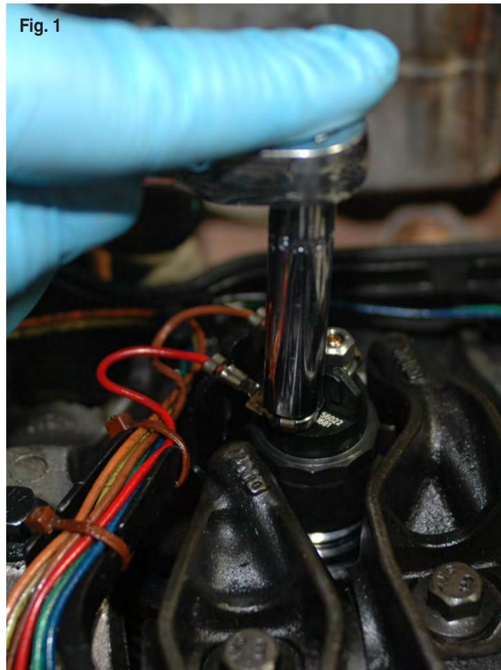
2. Retire las tuercas de los conectores eléctricos del inyector y mueva el arnés de cableado lejos del inyector. Las tuercas deberían ser parte del arnés de cableado. Si salen, tenga cuidado de no dejarlas caer dentro del motor y no las vuelva a utilizar. Instale una nueva empaquetadura en la tapa de la válvula (Fig. 1).
