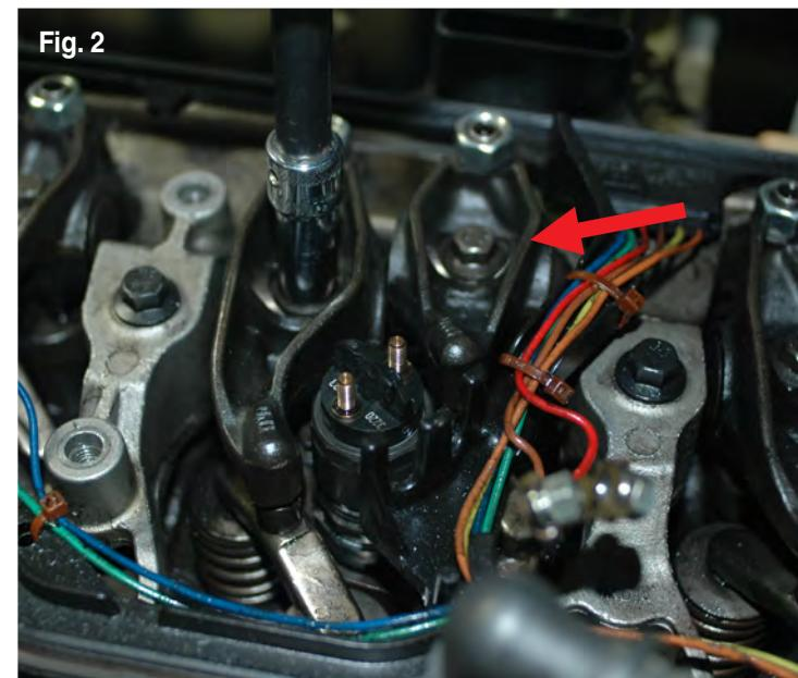
3. Retire los balancines de escape correspondientes a los inyectores que se van a cambiar. Márquelos y organícelos para asegurarse de volver a colocarlos en el cilindro igual que como vinieron originalmente (Fig. 2).
