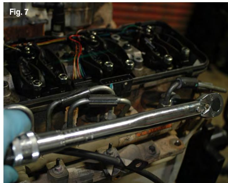
12. Apriete finalmente el tubo de alimentación y de conexión y la tuerca de retención. Apriete a un par de torsión de **50 N.m (37 libras-pie)** (Fig. 7).
