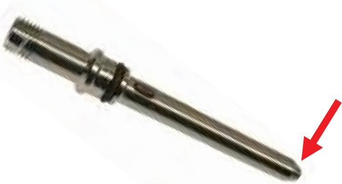
**10.** Comme ce guide l'indique au début, il est recommandé de remplacer les tubes de raccordement. S'il faut les réutiliser, examiner soigneusement la partie conique du connecteur. Si des rainures ou des égratignures visibles sont décelées, le connecteur ne sera sans doute pas étanche et il y aura une fuite (fig. 6).
