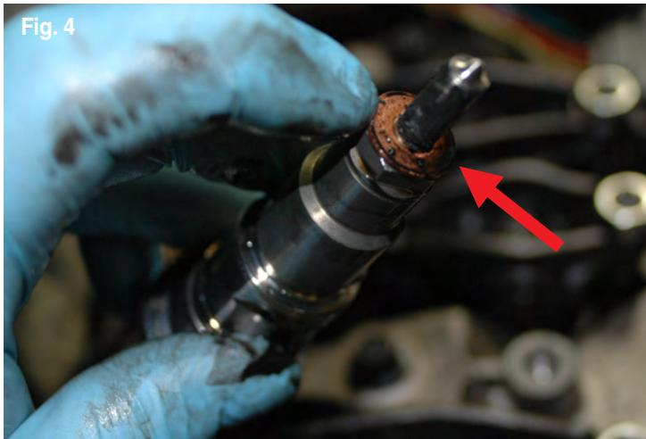
5. Une fois que l'injecteur est retiré, s'assurer que la rondelle de cuivre située autour de la buse est aussi retirée. Dans le cas contraire, vérifier l'alésage et retirer la rondelle, faute de quoi l'injecteur de rechange ne serait pas serré correctement et fuirait (fig. 4).
