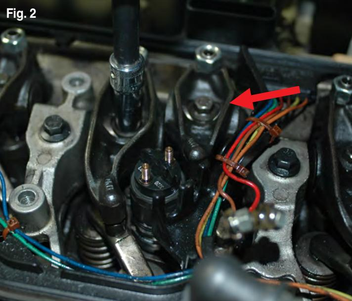
3. Retirer les culbuteurs d'échappement correspondant aux injecteurs qui doivent être remplacés. Marquer et organiser ces injecteurs pour s'assurer que chacun sera réinstallé sur son cylindre original (fig. 2).
