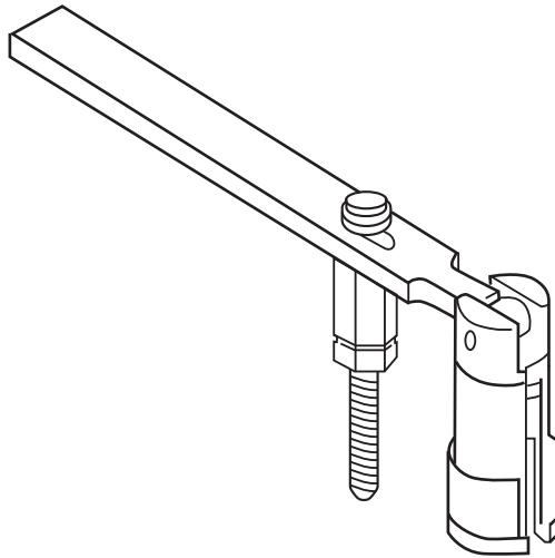
4. Après le retrait des connecteurs, des culbuteurs d'échappement et des tubes d'alimentation, tirer l'injecteur et le retirer de son alésage. Si l'injecteur est grippé ou qu'il est difficile à enlever, utiliser l'outil spécial n° 9010 recommandé; fixer l'outil tout autour de l'injecteur pour en faciliter le retrait. L'utilisation de tout autre outil peut endommager l'injecteur (fig. 3).
