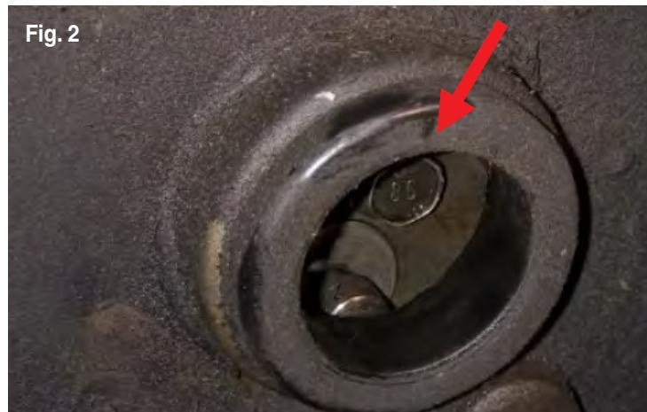
1. Retirar el tubo de llenado de aceite le da acceso a los pernos de retención de la bomba. Consejo importante: retire la arandela que sella el tubo de llenado a la tapa de la caja de distribución. La abertura es muy estrecha con la arandela puesta. El trabajo para retirar la bomba de inyección se duplicará si deja caer los pernos de retención dentro de la tapa de la caja de distribución. Vea las imágenes y las flechas rojas como referencia (Fig. 1 y Fig. 2).
