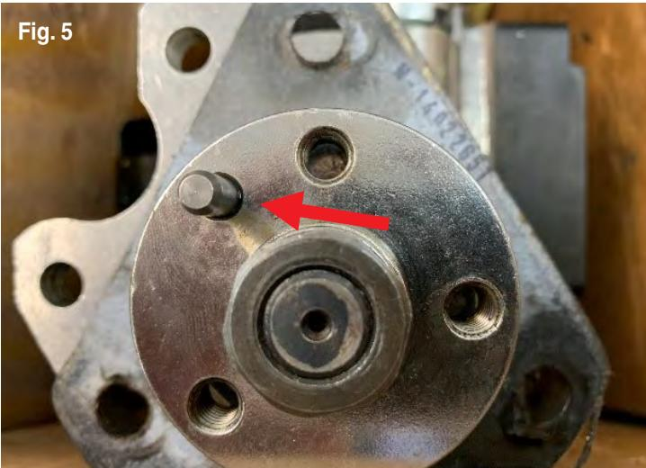
**10.** Installer le pignon de la pompe d'injection. S'assurer d'aligner la rainure du pignon de la pompe d'injection avec la tige repère du moyeu de la pompe (fig. 5).
