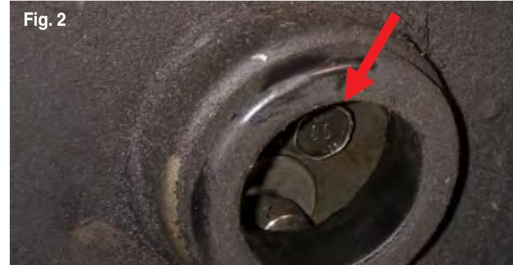
1. Le retrait du tube de remplissage d'huile donne accès aux boulons de retenue de la pompe. Ce qui importe, c'est d'enlever l'anneau qui scelle le tube de remplissage sur le carter de distribution. L'ouverture est très serrée lorsque l'anneau est en place. Le temps qu'il faut pour retirer la pompe d'injection sera multiplié par deux si les boulons de retenue tombent dans le carter de distribution. Voir les images et les flèches rouges (fig. 1 et 2).
