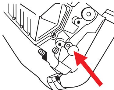
12. Vuelva a colocar y apriete los tapones de drenaje de los cabezales de los cilindros del segundo paso de este proceso y vuelva a colocar la empaquetadura de la cubierta de válvulas y la cubierta. Para asegurar la lubricación y suministro apropiados al momento del arranque, bombee gasolina a los inyectores girando la llave a ACC (contacto) durante 15 segundos y luego apague (OFF). Repita 3 o 4 veces, luego arranque el vehículo (Fig. 10).
