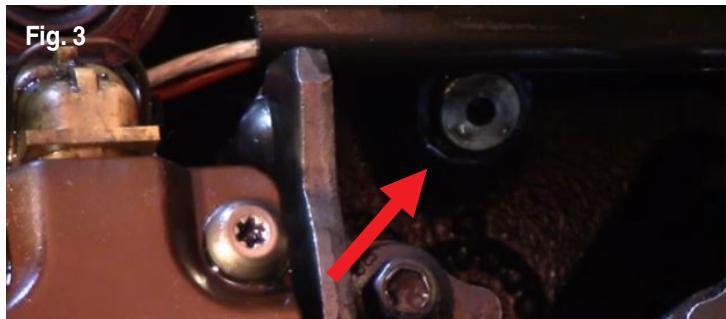
3. Afloje los tapones de drenaje ubicados detrás de cada cabezal de cilindro. Hacer esto ayudará a evitar que retornen fluidos que no deberían ingresar a la cámara de combustión (Fig. 3).
