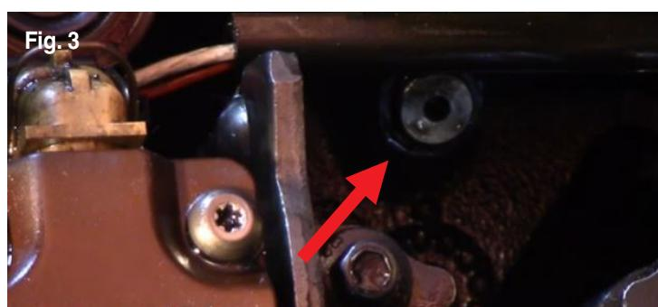
3. Desserrer les bouchons de vidange situés à l'arrière de chaque culasse, et ce, afin de favoriser le refoulement de fluides qui ne doivent pas pénétrer dans la chambre de combustion (fig. 3).
