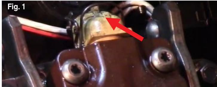
1. Desconecte el arnés eléctrico que está en la empaquetadura de la cubierta de válvulas de cada inyector. Para facilitar la desinstalación e instalación, desconecte y desinstale toda la empaquetadura (Fig. 1).
