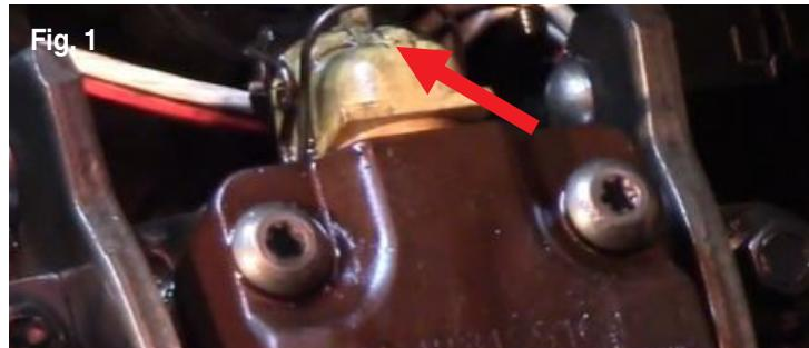
1. Débrancher le faisceau électrique, situé sur le joint de couvercle de soupapes, de chaque injecteur. Pour faciliter la dépose et l'installation, débrancher le faisceau et retirer tout le joint d'étanchéité (fig. 1).
