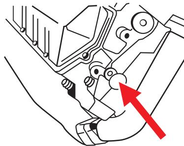
11. Réinstaller et serrer les bouchons de vidange d'huile dans les culasses. Serrer à **6 N.m (53 lb-po)** (fig. 9).
