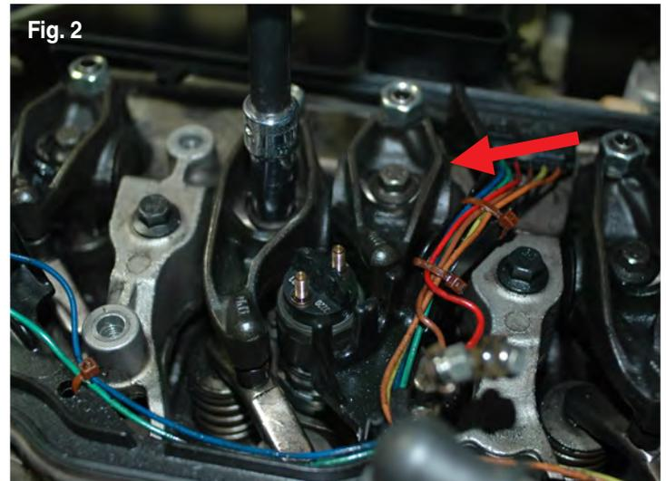
3. Retire los balancines de escape correspondientes a los inyectores que se van a cambiar. Márquelos y organícelos para asegurarse de volver a colocarlos en el cilindro igual que como vinieron originalmente (Fig. 2).
