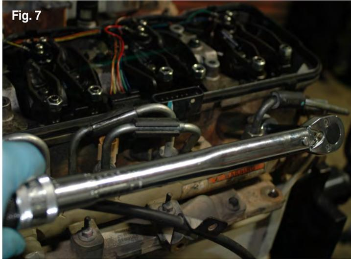
12. Apriete finalmente el tubo conector de alimentación y la tuerca de retención. Apriete a un par de torsión de **50 N.m (37 libras-pie)** (Fig. 7).
