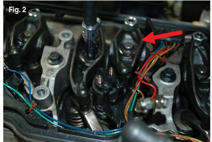
3. Retirer les culbuteurs d'échappement correspondant aux injecteurs qui doivent être remplacés. Marquer et organiser ces injecteurs pour s'assurer que chacun sera réinstallé sur son cylindre original (fig. 2).
