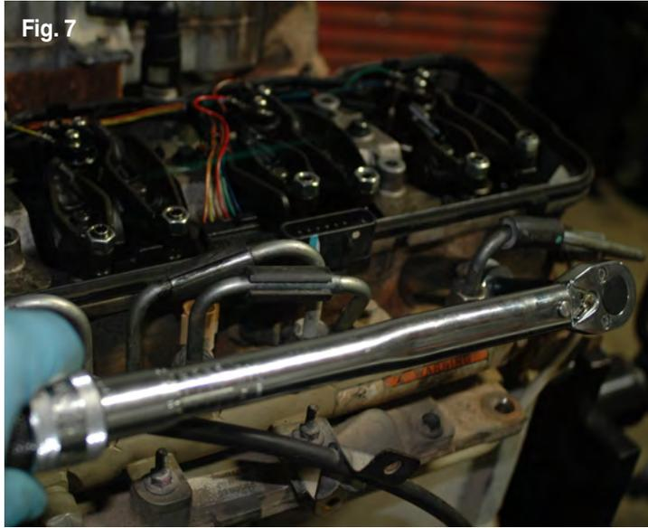
12. Effectuer le dernier serrage du tube d'alimentation/de connexion et de l'écrou de retenue. Serrer à un couple de **50 N.m (37 lb-pi)** (fig. 7).
