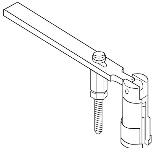
4. Después de retirar los conectores, el balancín del escape y los tubos de alimentación, ya puede jalar el inyector y retirarlo del orificio. Si ve que el inyector se atasca o es difícil de retirar, use la herramienta especial recomendada n° 9010 (Fig. 3) para engazarla alrededor del inyector para retirarlo. Usar otra herramienta puede dañar el inyector.
