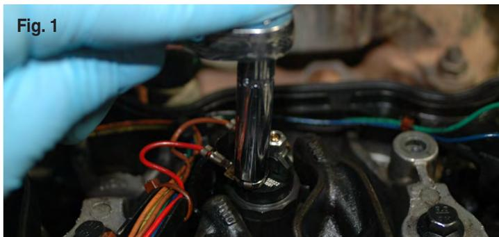
2. Retire las tuercas del conector eléctrico al inyector y póngalas a un lado. Cada tuerca del conector eléctrico debe quedarse acoplada a su extremo del conector del arnés de cableado. Si alguna de las tuercas del conector no permanece acoplada, debe tener cuidado para asegurarse de que no caiga dentro de áreas vulnerables del motor. Si reemplaza los seis inyectores, lo más fácil es desconectar todos los conectores y retirar la empaquetadura de la cubierta de la válvula completamente (Fig. 1).
