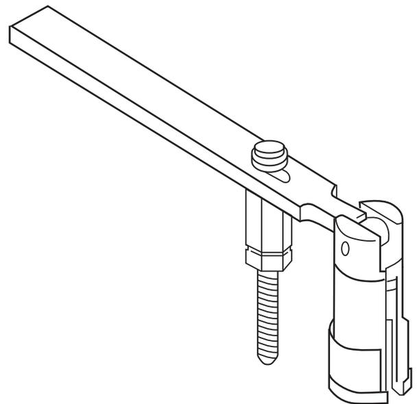
4. Après le retrait des connecteurs, des culbuteurs d'échappement et des tubes d'alimentation, tirer l'injecteur et le retirer de son alésage. Si l'injecteur est grippé ou qu'il est difficile à enlever, utiliser l'outil spécial n° 9010 recommandé (fig. 3); fixer l'outil tout autour de l'injecteur pour en faciliter le retrait. L'utilisation de tout autre outil peut endommager l'injecteur.
