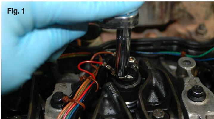
2. Retirer les écrous du connecteur électrique de l'injecteur et les mettre de côté. Chacun des écrous de connecteur électrique doit rester attaché à la terminaison du connecteur du faisceau électrique. Si un écrou se détache, s'assurer qu'il ne tombe pas dans des zones vulnérables du moteur. Si les six injecteurs doivent être remplacés, il est plus simple de débrancher tous les connecteurs et de retirer intégralement le joint de couvre-soupapes (fig. 1).
